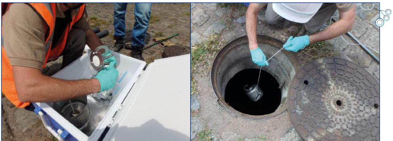
Figure 7 : Illustration du montage et du déploiement en réseau d'assainissement d'échantillonneurs intégratifs de type POCIS (Source : M.J. Capdeville, Suez – Regard)
