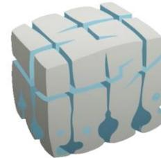
fissures élargies par la dissolution, ET vides organisés en réseau de drainage souterrain hiérarchisé
